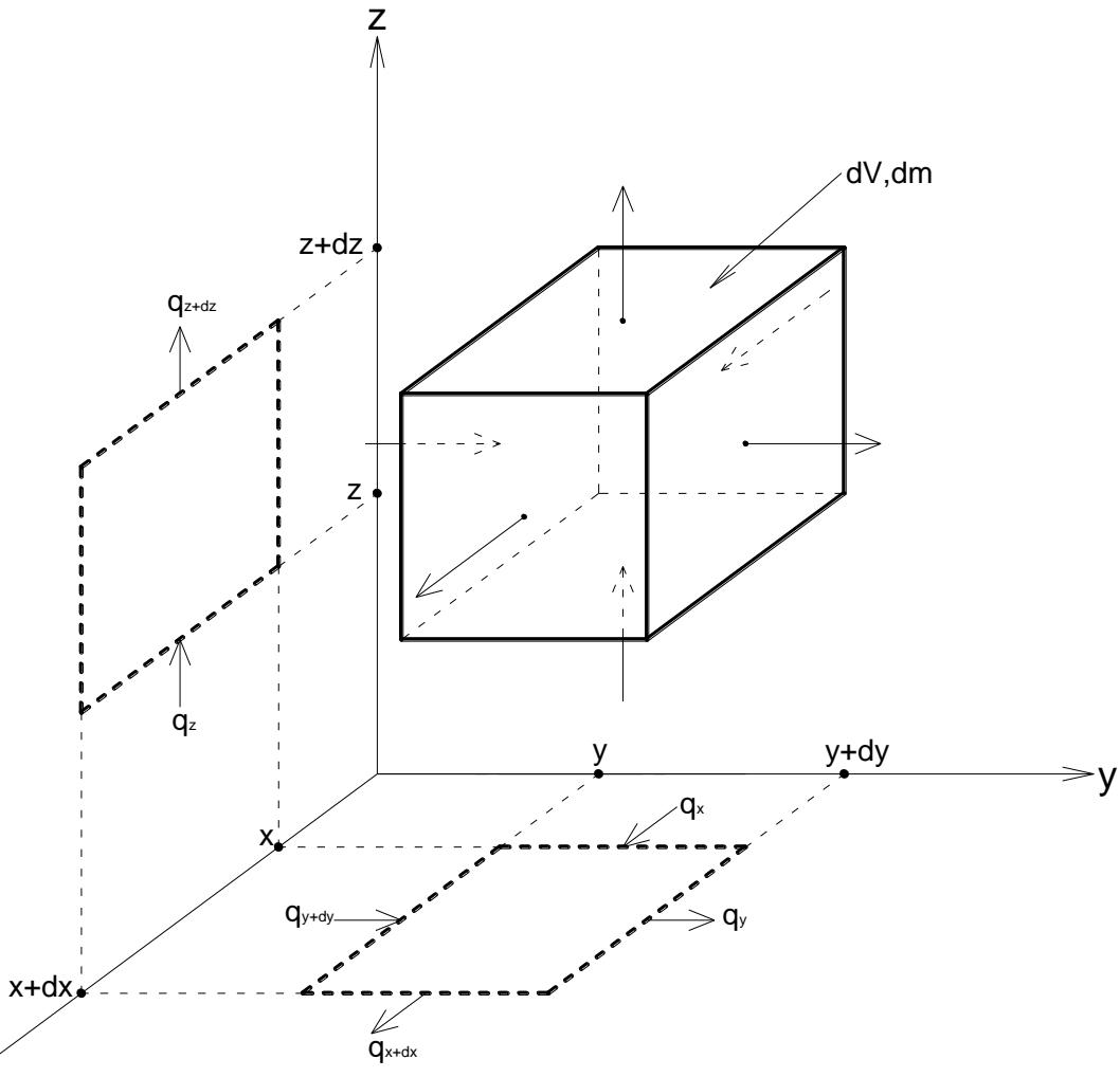
Ivođenje jednačine se svodi na pisanje bilansnih jednačina za provođenje topline kroz uočenu zapreminu za sva tri pravca:  $x$ ,  $y$  i  $z$ . To znači pisanje izraza za toplotu koja ulazi kroz jednu površ, a izlazi kroz njoj paralelnu drugu površ, i tako za sva tri pravca. (Na slici to su gustine toplotnih flukseva:  $q_x$ ,  $q_{x+dx}$ ,  $q_y$ ,  $q_{y+dy}$ ,  $q_z$ ,  $q_{z+dz}$  gde su indeksi koordinate paralelnih površi.)
